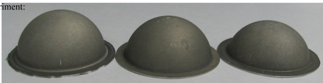
圖 8 時間 t=1800 秒時，吹製成型試體變形圖與 FEM 分析結果比較圖
